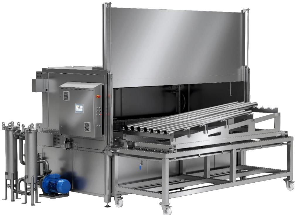
Die Waschanlage wurde für die effektive und wirtschaftliche Reinigung und Entfettung von Zylinderrohren in Zylinderherstellungsbetrieben entwickelt.
