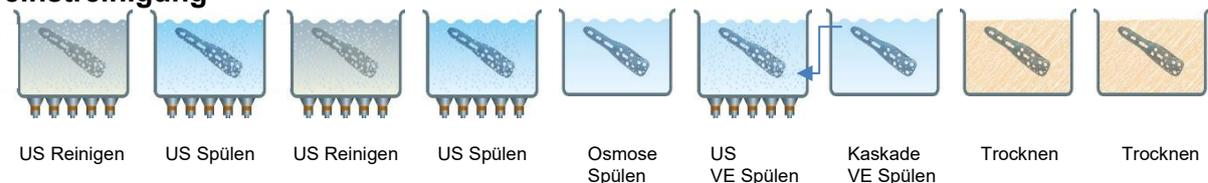
Je nach Verschmutzung und Reinheitsanforderungen wird der Reinigungsprozess durch Versuche ermittelt und definiert. Basierend auf dem Reinigungsprozess wird die Reinigungslinie mit den nötigen Wannen zusammengestellt. Meistens beansprucht die Trocknung die meiste Zeit. Wird die Anzahl der Trockner erhöht, nimmt der Korbausstoß pro Zeiteinheit entsprechend zu. Durch eine Kaskade zwischen zwei Spülbecken lässt sich der Wasserverbrauch minimieren.
