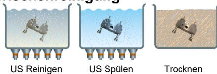
Je nach Anwendung (z.B. nach dem Sandstrahlen) kann das Spülbecken zusätzlich mit einem Filterkreislauf ausgerüstet werden, um die Badstandzeit zu erhöhen.
