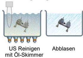
Demulgierende Reiniger werden mit dem Öl-Skimmer entfernt, die Einsatzdauer des Reinigungsmediums wird dadurch erhöht.
