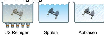
Stark verschmutzte Teile können einfach und effizient von Öl, Fett oder partikulären Verschmutzungen befreit werden. Je nach Anforderung werden die Teile "nur" gereinigt, teils noch mit Wasser gespült oder zusätzlich mit Pressluft abgeblasen.
