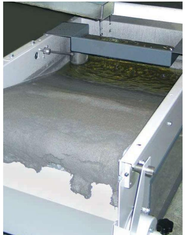
DIE VERSCHMUTZTE FLÜSSIGKEIT WIRD IN DEN TROG EINGELEITET, WELCHER SIE EINHEITLICH AUF DEM UNTEREN BEREICH VERTEILT. DANK DER BESONDEREN FORM DER GENEIGTEN RAMPE ERHÄLT MAN IM ERSTEN ABSCHNITT EINE WASSERSÄULE MIT EINEM TIEFEN ANSCHLAG, IN WELCHEM SICH DER SCHADSTOFF ABLAGERT. DER SCHADSTOFF ERFAHRT VOR DER TRENNUNG VOM FILTERGEWEBE EINE TROCKNUNGSPHASE.
