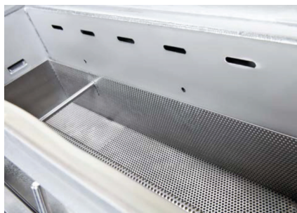
Normwanne mit Überlaufftasche, Grobfilter und integrierter Absaugung
