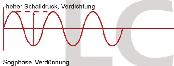
Durch die vom Ultraschall erzeugten Druckschwankungen (Expansion und Kompression) zerreißen die Flüssigkeitsbindungen und es entstehen transiente und blasenartige Hohlräume (Blasen), die sofort durch Verdampfen der Flüssigkeit an der Grenzfläche des Hohlraums mit Flüssigkeitsdampf gefüllt werden. In der Kompressionsphase kondensiert der Dampf wieder.
